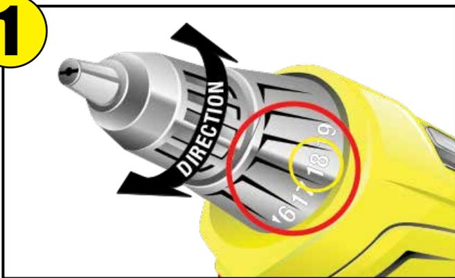
**TOUJOURS** vérifier le sens et le réglage de couple de la perceuse sans fil avant de l'insérer dans le bras inférieur.
